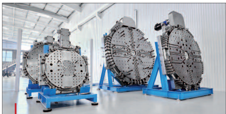
Le centre d'essais de moules est équipé de tables et bases tournantes de grande taille.
